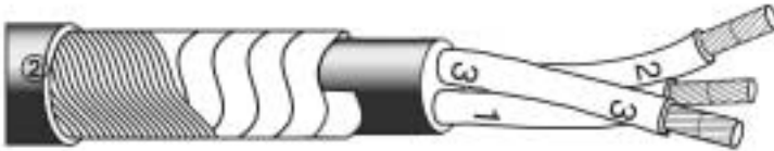
Capa de cinta de cobre con capa concéntrica de cable de cobre.
