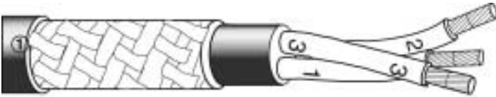
Cable de acero galvanizado o de cobre estañado con pantalla trenzada.
