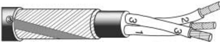
Capa concéntrica de cables de cobre con una hélice abierta de cinta de cobre.
